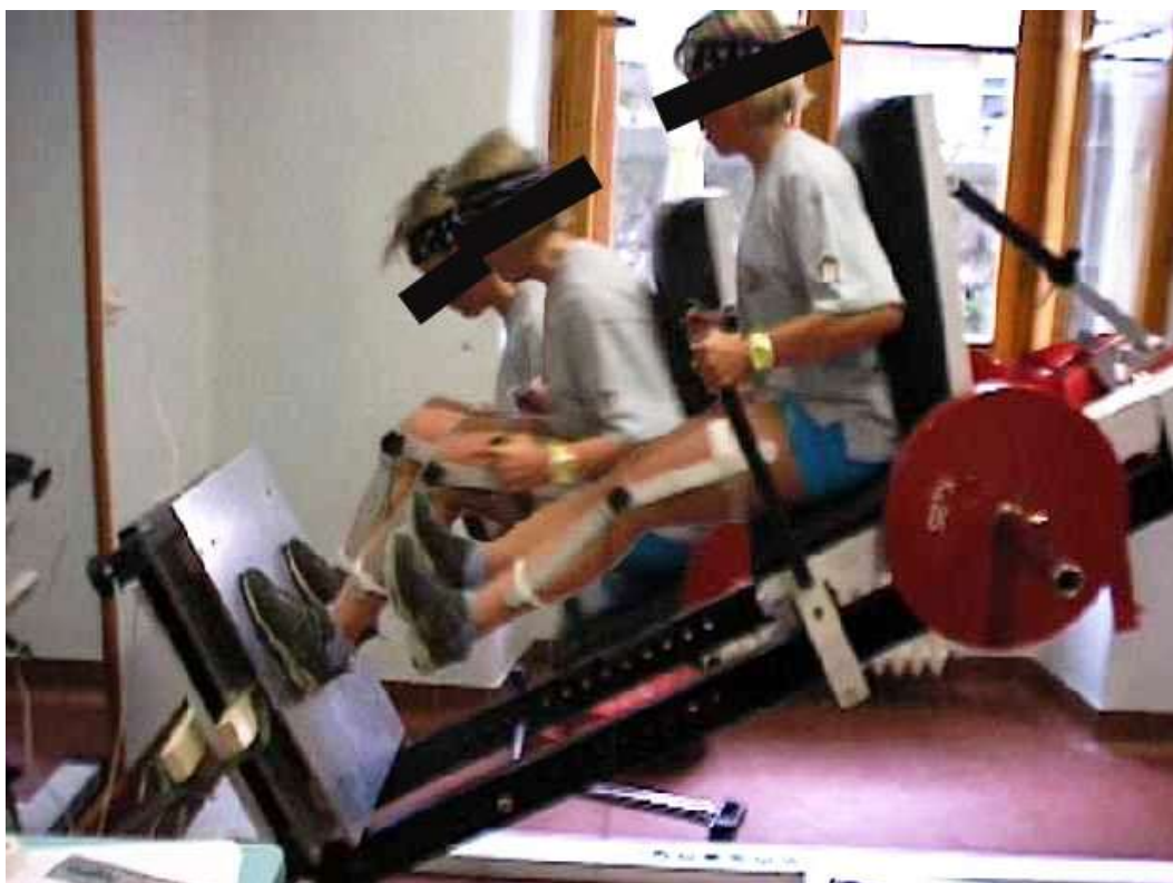
Il test dinamico registra la forza concentrica e eccentrica espressa, elaborando i valori di potenza e di velocità degli arti inferiori a vari angoli del ginocchio
